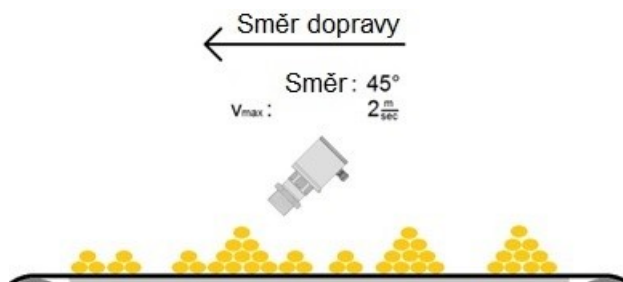
Obr. 1 Montáž nad pásovým dopravníkem
