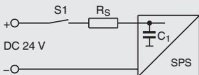
$R_S = 22 \Omega$  (47  $\Omega$  für Kontakte  $\leq 10 \text{ VA}$ )
