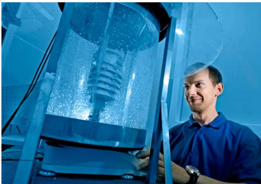
Přístroj WXT520 v dešťové komoře výrobního závodu Vaisala
