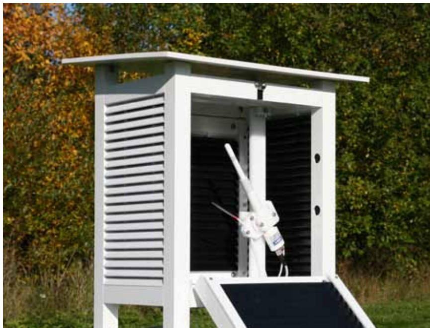
Sonda HMP155 s novým stabilním senzorem HUMICAP®180R a s přídatnou teplotní sondou v Stevensonově meteorologické budce
